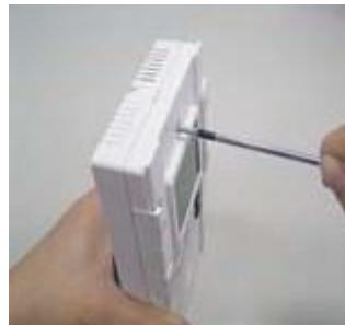
3. Вложить плоскую отвертку в отверстие - вырез на верхней панели устройства
