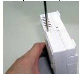
4. Легко нажать защелку отверткой и вскрыть корпус.
