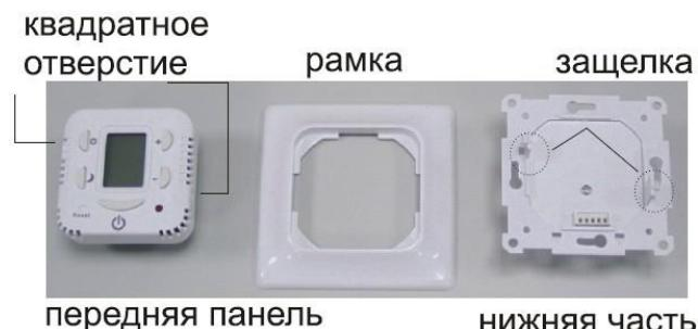
Корпус термостата состоит из трех пластмассовых частей: передняя панель, рамка и нижняя часть. Они соединены уникальной системой защелок. Защелка проходит от нижней части через центральную часть рамки, затем входит в два маленьких квадратных отверстия справа и слева передней панели (обратите внимание на нижеследующие снимки).
