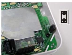
Датчик температуры помещения включен (заложен якорек)
